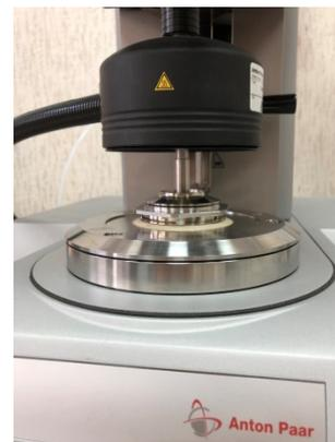
Система плита-плита с верхним кожухом, реометр Physica MCR 102
