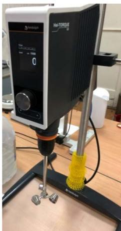
Верхнеприводная мешалка Heidolph с мешальником ViscoJet
