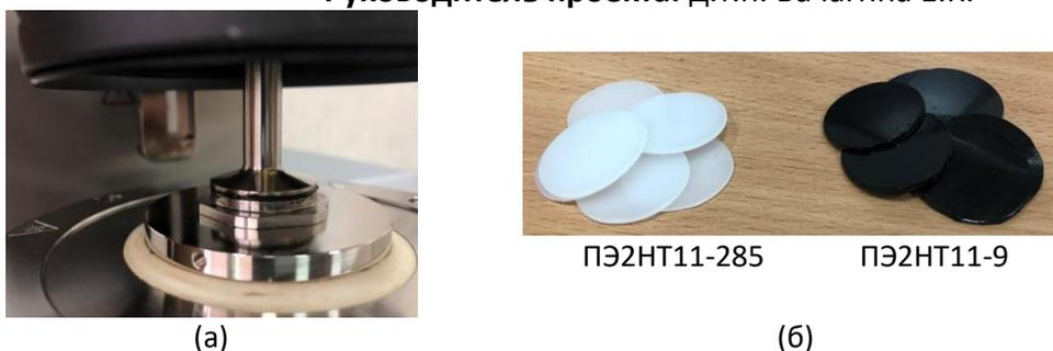
**Рис. 1. (а) Измерительная система плита-плита (25 мм) с активным кожухом, (б) Образцы расплавов полимера**
